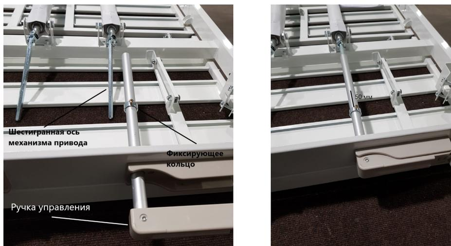
Рис. 7. Установка ручки управления привода
